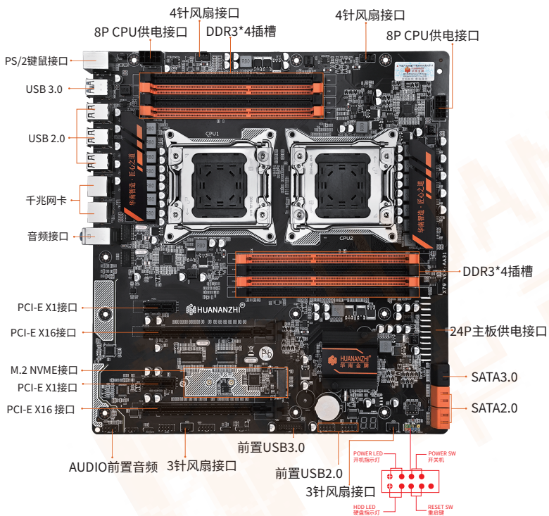
图1-1 X79-8D双路主板图解
